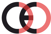
Falsche CE-Kennzeichnung (zu dicht)
